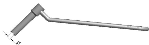
Ośłona gwintownika Protection sleeve for tap
