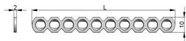
Płytką rekonstrukcyjną 10,0x2,0mm pod wkręty \varnothing 3,5 i \varnothing 4,0mm Reconstruction plate 10,0x2,0mm for screws \varnothing 3,5mm and \varnothing 4,0mm
